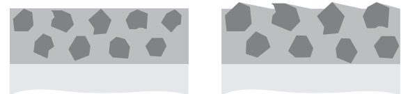
Abbildung 5: Ziel des Schärfens: Erzeugen von Kornüberständen (Mikrogeometrie)
