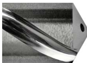
Bohrernut mit STARTEC XP-F poliert Rz=0,20 µm
