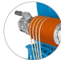
Hohe Kraftübertragung durch Mehrfachrollenantrieb
